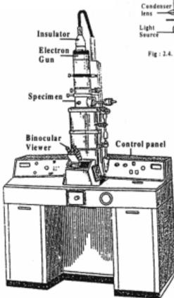
Fig : 2.5. An Electron Microscope
