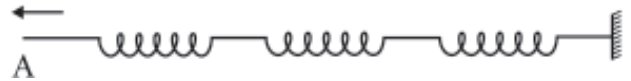
चित्र 15.1 एक-दूसरे से संबद्ध कमानियों का संग्रह। सिरे A को यकायक खींचा जाता है; तब विक्षोभ दूसरे सिरे तक संचरित हो जाता है।
